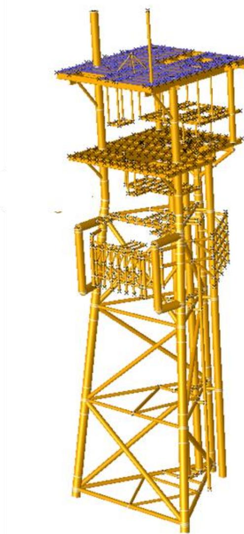
Gambar 2. 1 Pemodelan *Jacket Platform* 3D menggunakan *Software SACS*
