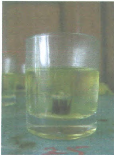
Gambar 3.11 Proses pengkorosian logam peleburan
