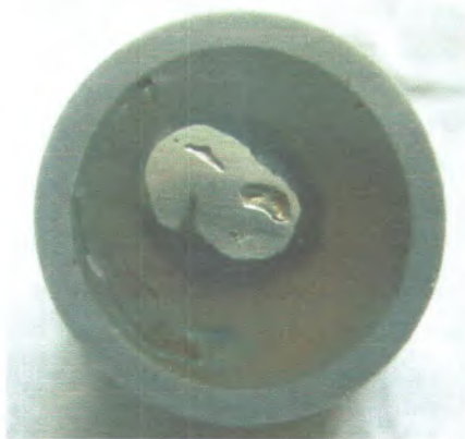
Gambar 4.5 Blow hole yang terjadi pada proses peleburan
