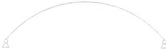
Gambar 2.8 Jembatan dengan dua sendi
