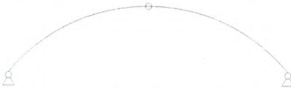
Gambar 2.9 Jembatan dengan tiga sendi
