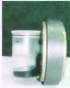
Gambar 4.1 Sensitifitas ferrofluida terhadap medan magnet
