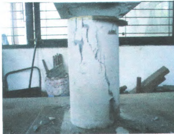
Foto Tes Tekan Benda Uji Silinder
