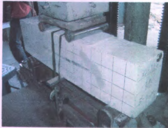
Foto Proses Pengujian Third Point Loading Test Pada Balok yang Telah Diperbaiki
