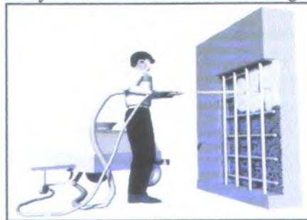
Gambar 2.11 Repair Dengan Metode Low Pressure Spraying
