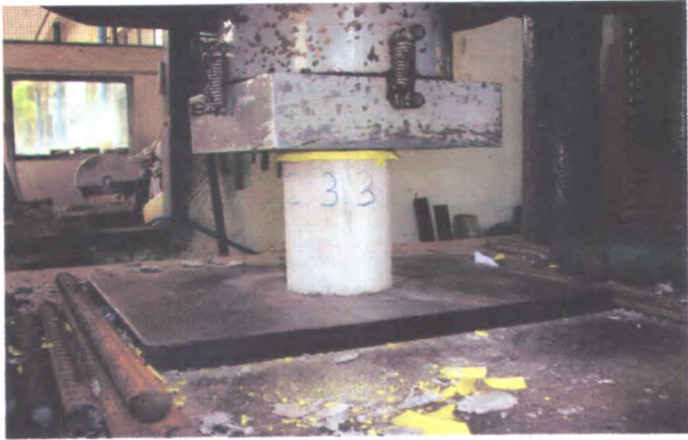
Gambar 4.9 : Benda uji dengan variasi L/D = 1.5 sebelum diuji tekan
