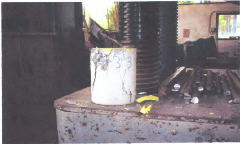
Gambar 4.10 : Benda uji dengan variasi L/D = 1.5 setelah diuji tekan
