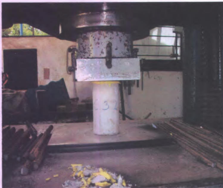
Gambar 4.8 : Benda uji yang akan diuji tekan
