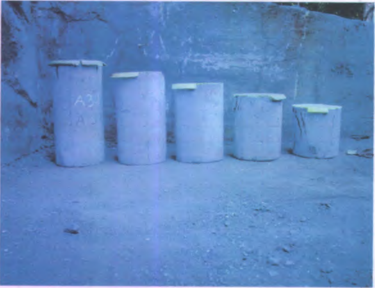
Gambar 4.11 : Benda uji dengan berbagai variasi L/D setelah diuji tekan
