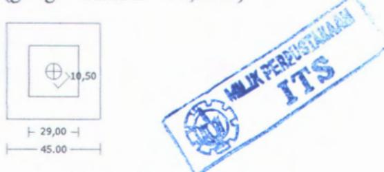
Gambar 5.13 Penampang blok angker pada balok untuk tendon 1 dan 2
