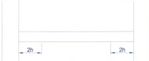
Gambar 2.4 Daerah dimana leleh lentur terjadi akibat deformasi inelastik struktur rangka (2h)
