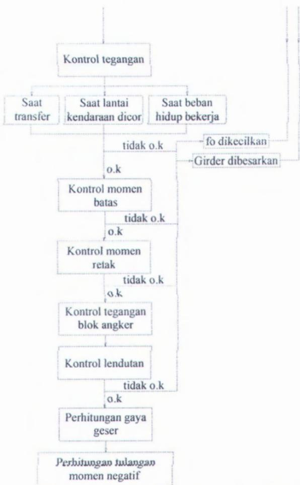
Gambar 2.16 Flowchart perhitungan struktur bangunan atas utama (super struktur)
