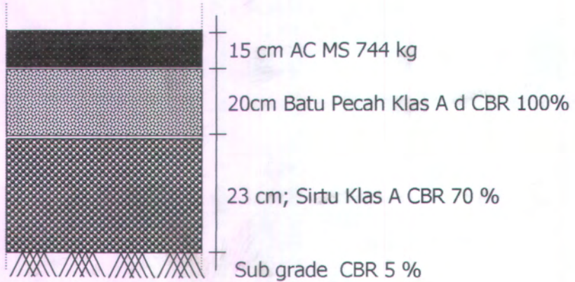
Gambar 5.9. Rencana Tebal Perkerasan
