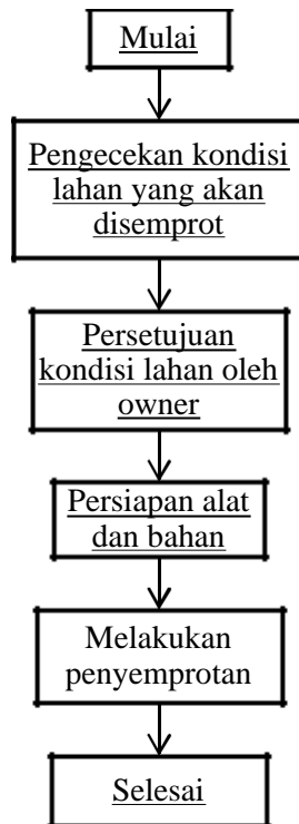
Gambar 2.11 Flowchart Pekerjaan Penyemprotan Anti Rayap
