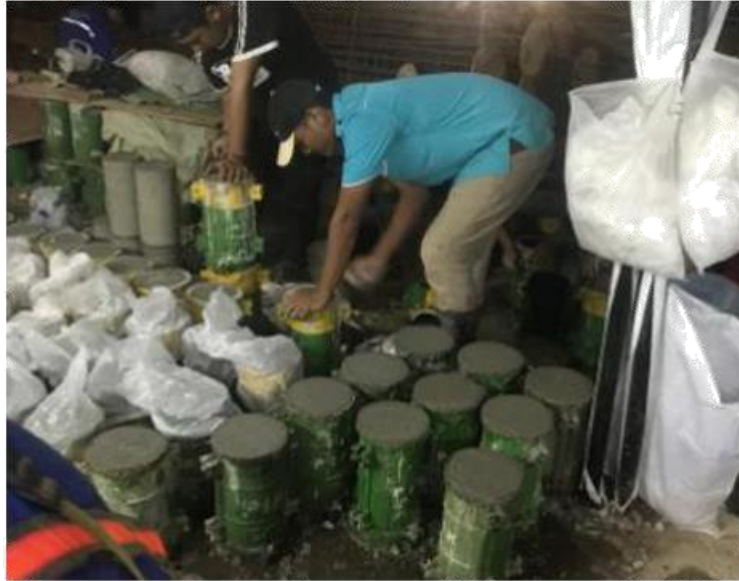
Gambar 2.51 Pengambilan Sampel Beton
