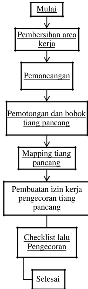
Gambar 2.4 Flowchart Pemancangan Spun Pile
