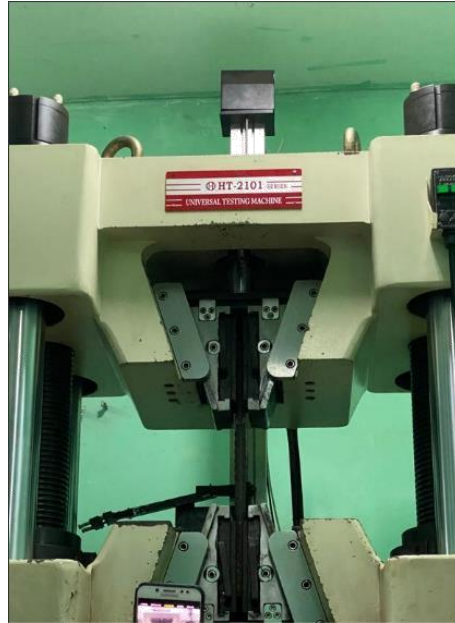
Gambar 2.23 Pengujian Kuat Putus
