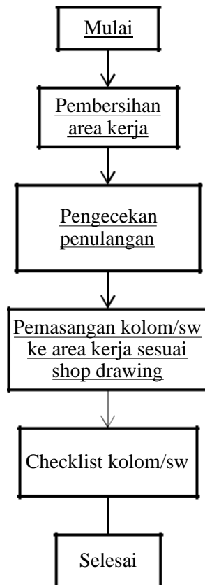
Gambar 2.30 Flowchart Pekerjaan Pembersian Sheer Wall atau Kolom
