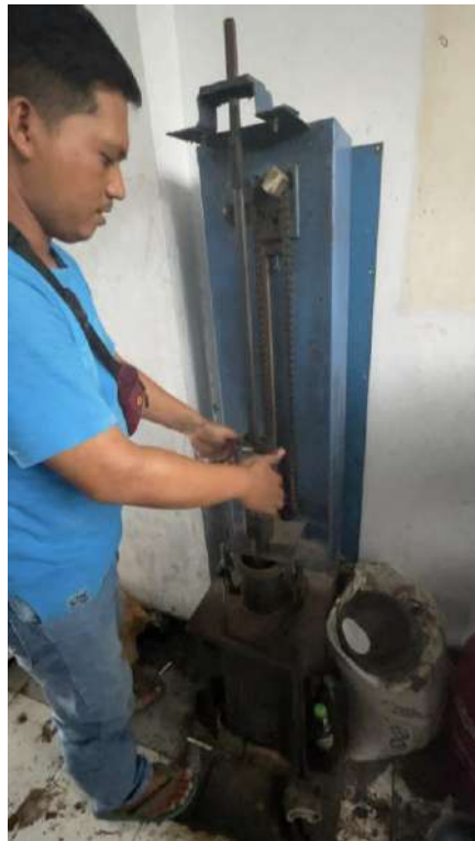
Gambar 3. 37 Penumbukan Benda Uji dengan Asphalt Compactor 75 Kali
