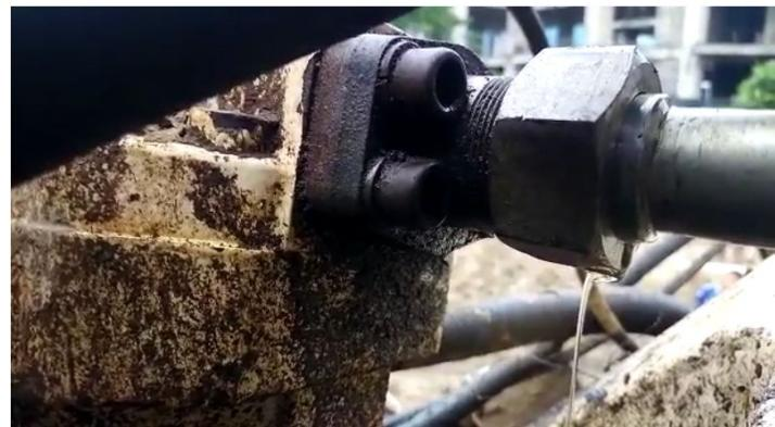
**Gambar 4.44** Kebocoran selang pipa hidrolik pada mesin bor
