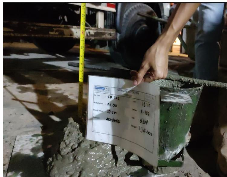
**Gambar 4.41** Pengukuran nilai slump
