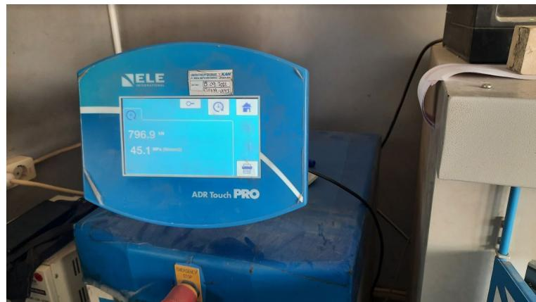
**Gambar 4.18** Nilai Kuat Tekan Beton Dari Hasil Uji Pada Mesin
