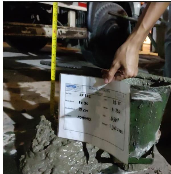
Gambar 4.16 Pengukuran Nilai Slump Beton
