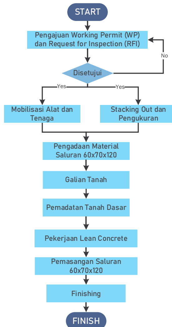
Gambar 2 24 Diagram Alir Pekerjaan Saluran Pracetak (Sumber: Dokumen PT Wijaya Karya BKU KSO, 2022)
