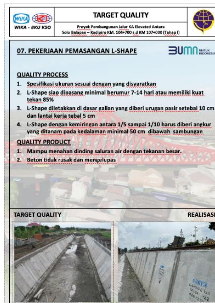
Gambar 2 2 Pembuatan Buku Saku Target Quality Pekerjaan Pemasangan L-Shape
