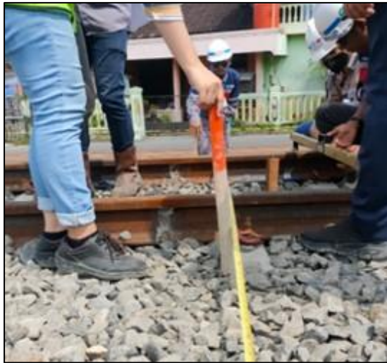
Gambar 2.60 Pengukuran Profil Ballast
