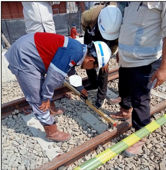
Gambar 2.60 Pengukuran Profil Ballast
