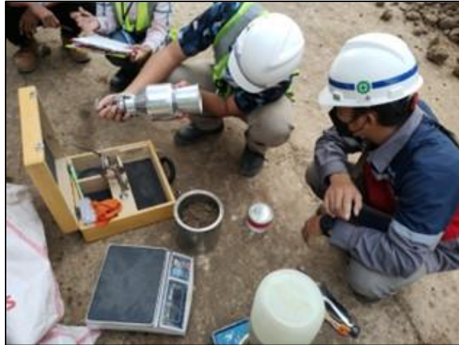
Gambar 2.18 Pelaksanaan Uji Kadar Air Tanah
