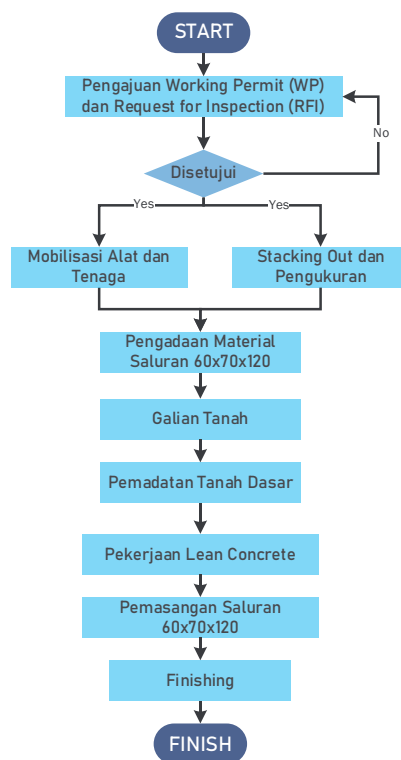
Gambar 2.15 Flowchart Pekerjaan Saluran Pracetak (U-Ditch)
