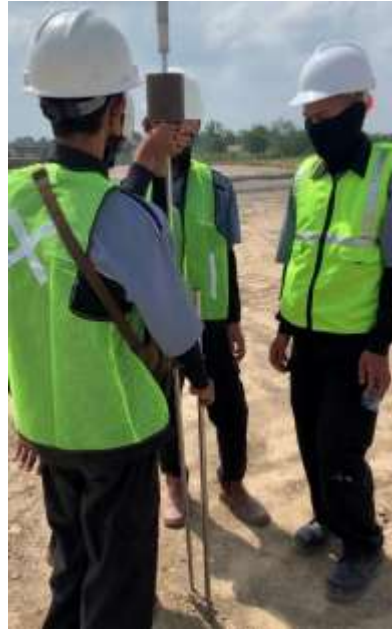
Gambar 2.33 Proses Penjatuhan Alat Pemberat pada Pengetesan DCP
