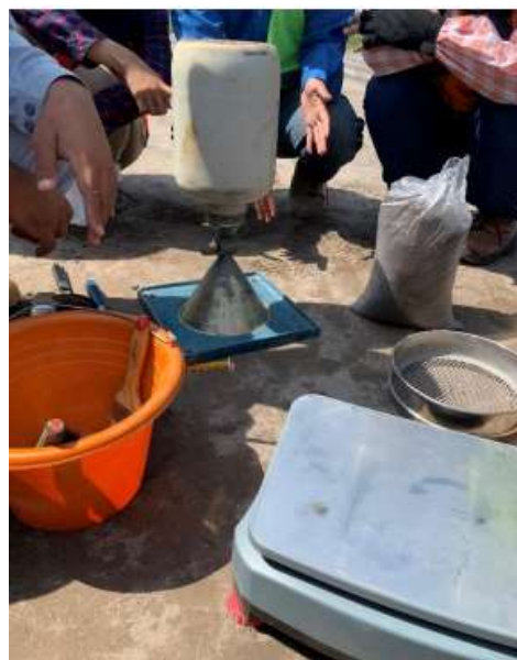
Gambar 2.60 Tabung Kuarsa yang Sedang Ditumpahkan Kedalam Lubang Tanah
