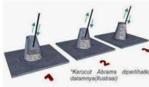
Gambar 2.73 Ilustrasi Tata Cara Pengujian Slump Test
