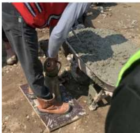
Gambar 2.72 Proses Memasukkan Mix Desain kedalam Kerucut Abrams
