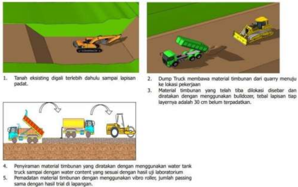
Gambar 2.11 Ilustrasi Pekerjaan Timbunan Tanah
