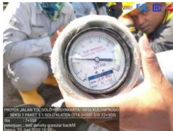
Gambar 2.40 Contoh Pembacaan Speedy Test
