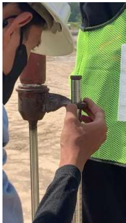
Gambar 2.34 Alat Ukur Penurunan Kedalam pada Uji DCP
