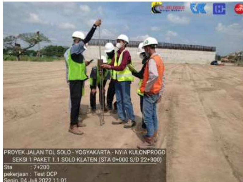
Gambar 2.32 Peletakan Alat DCP pada Titik yang Telah Ditentukan
