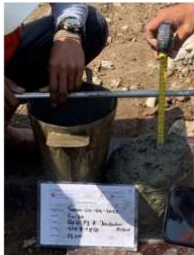
Gambar 2.43 Proses Pengukuran Penurunan Slump Test
