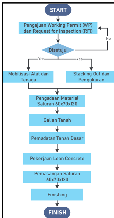
Gambar 2. 14 Flowchart Pekerjaan Pemasangan U-ditch
