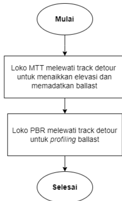
Gambar 2. 23 Alur Pekerjaan MTT
