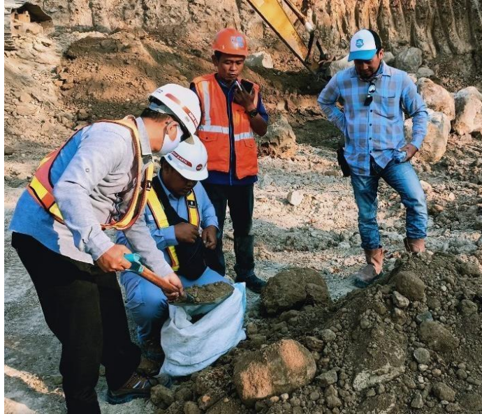
Gambar 3.8 Proses Pengambilan Sampel Tanah di Quarry Sobokerto
