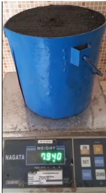
*Gambar 8.4 Agregat kasar (split) ditimbang*
