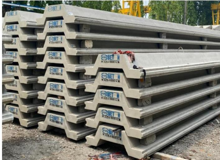
*Gambar 2.5.5 Hasil jadi beton setelah proses curing*
