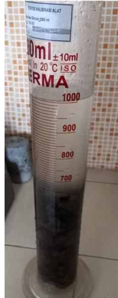
*Gambar 1.2 Uji pemeriksaan kadar lumpur agregat halus (pasir)*
