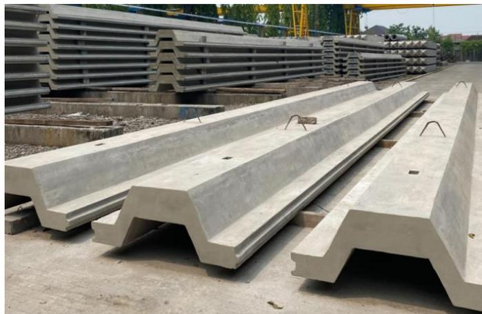
*Gambar 2.5.6 Hasil jadi beton setelah proses curing*
