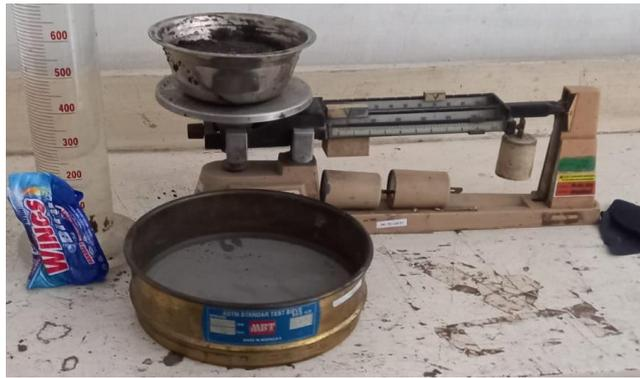
Tabel 3.1 Alat uji dalam agregat halus yang lolos saringan No.200
