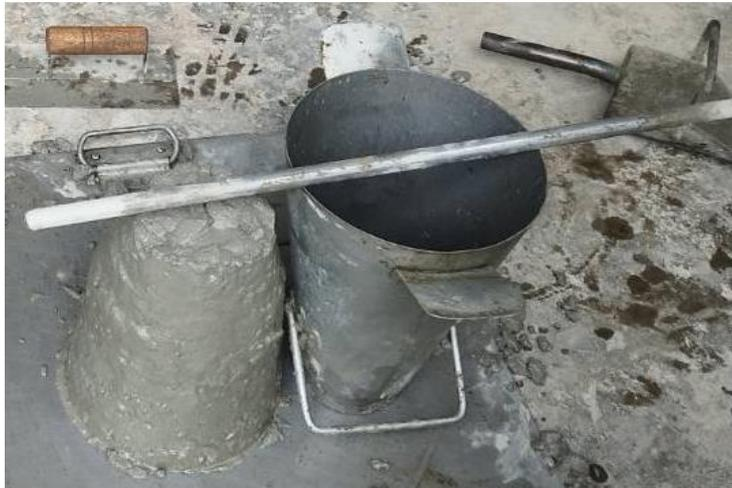
*Gambar 2.5.1 Uji slump*
