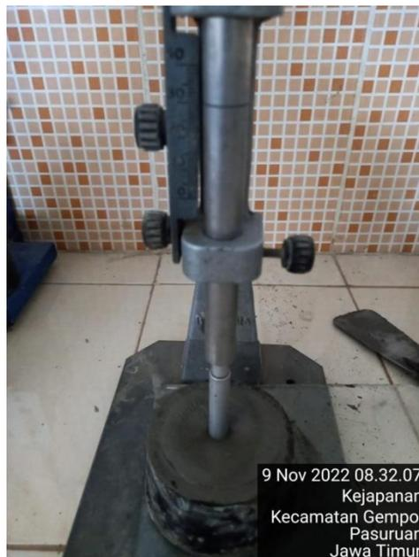
Gambar 3.1.2 Percobaan penetrasi
