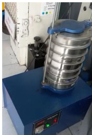
*Gambar 5.3 Mesin pengguncang saringan*
