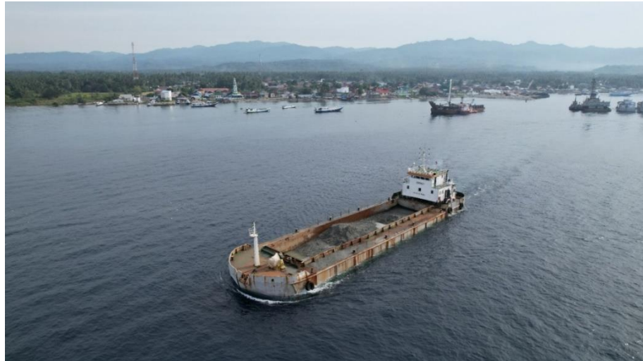
Gambar 3.43 Hopper Barge pada saat Menuju Dumping Area (Sumber: PT. Wijaya Karya, 2022)
