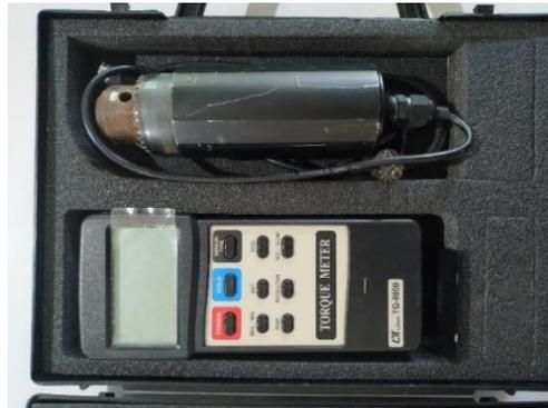
Gambar 3.8. *Static Torquemeter* Lutron TQ-8800
