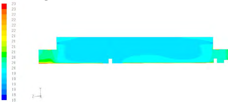
Gambar 4.1 Kontur Temperatur Bidang x/l=0,64 Untuk Variasi Siang
