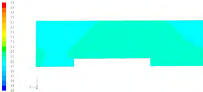
Gambar 4.23 Kontur Temperatur Bidang z/w=0,65 Untuk Variasi Malam
