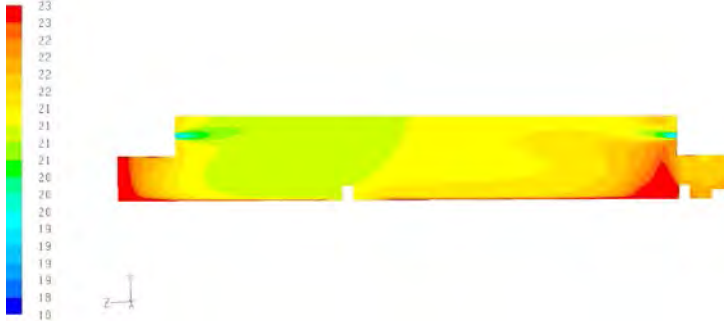
Gambar 4.31 Kontur Temperatur Bidang x/l=0,64 Untuk Variasi Malam
