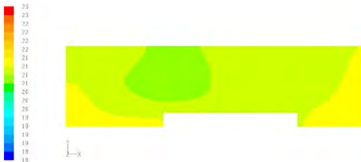
Gambar 4.35 Kontur Temperatur Bidang z/w=0,65 Untuk Variasi Malam
