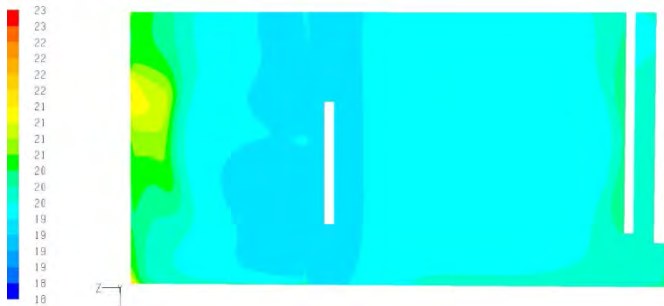
Gambar 4.3 Kontur Temperatur Bidang y/h=0,54 Untuk Variasi Siang
