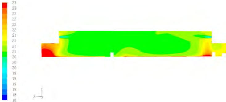
Gambar 4.25 Kontur Temperatur Bidang x/l=0,64 Untuk Variasi Malam
