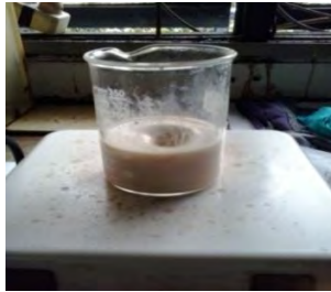
Gambar 3.3 Stirrer Serbuk Silika dan larutan NaOH
