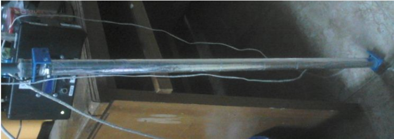
Gambar 3.4 Rancangan sensor level berbentuk silinder koaksial
