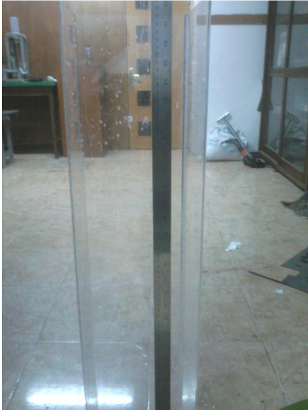
Gambar D.3 Tempat Penampung Air yang terbuat dari Akrilik dan sudah dipasang Kalibrator
