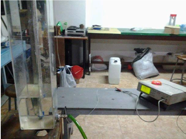
Gambar D.5 Gambar Pengambilan Data Kapasitansi saat Pengukuran Kenaikan Level 20 cm
