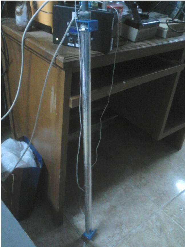
Gambar D.2 Bentuk Fisik Sensor Kapasitif untuk Level Air
