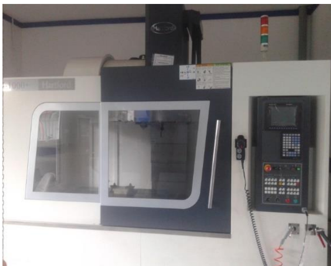
Gambar 2. 6 Mesin CNC Hartford LG-1000 (Sumber : Dokumentasi Pribadi)
