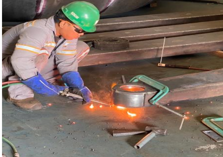
Gambar 4. 8 Proses Assembly Pada Pressure Rod Bottom
