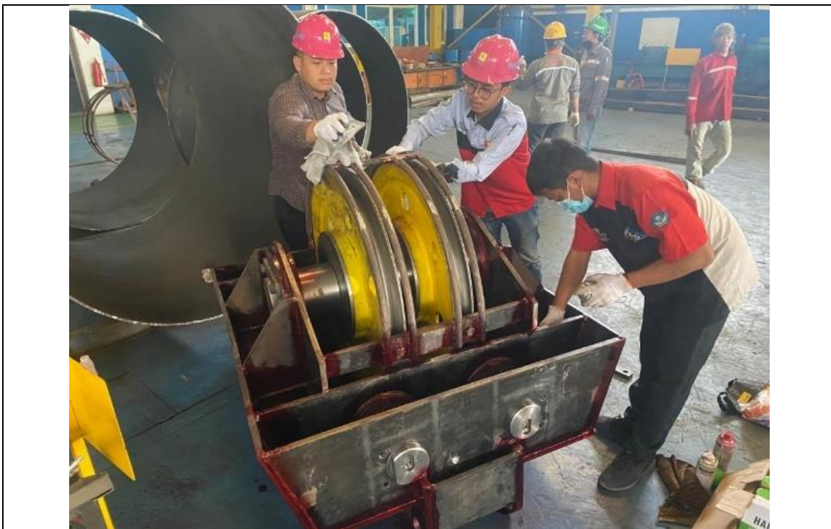
Quality Control menggunakan penetrant pada komponen Grab Bucket
