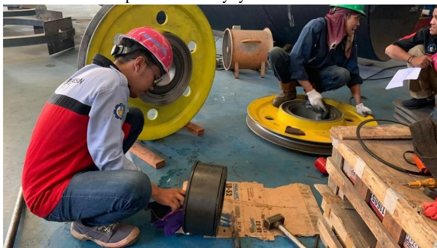
Gambar 4. 12 Proses Assembly Pada Traverse Assy dan Bush
