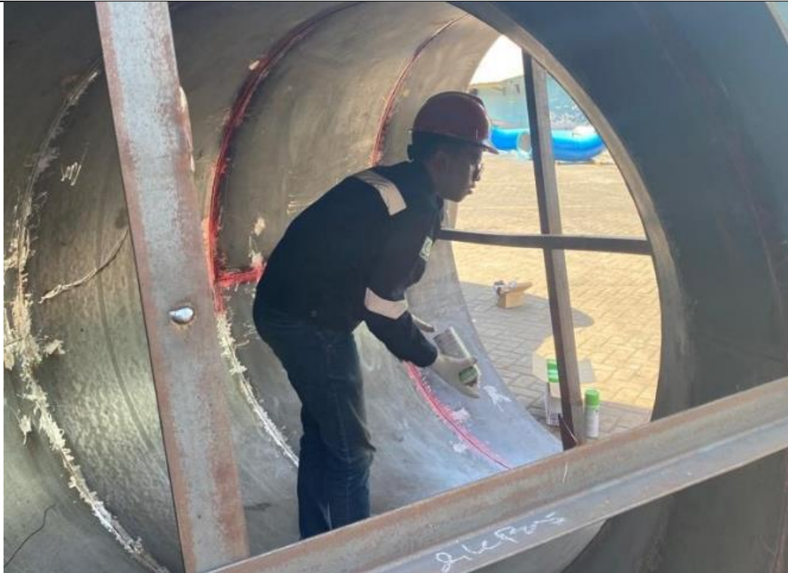
Quality Control Menggunakan Penetrant Test
