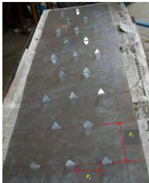
b) Obstacle dipasang di atas plat
