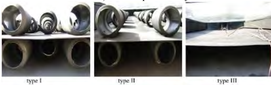
b) Obstacle yang digunakan di atas dan bawah plat penyerap
