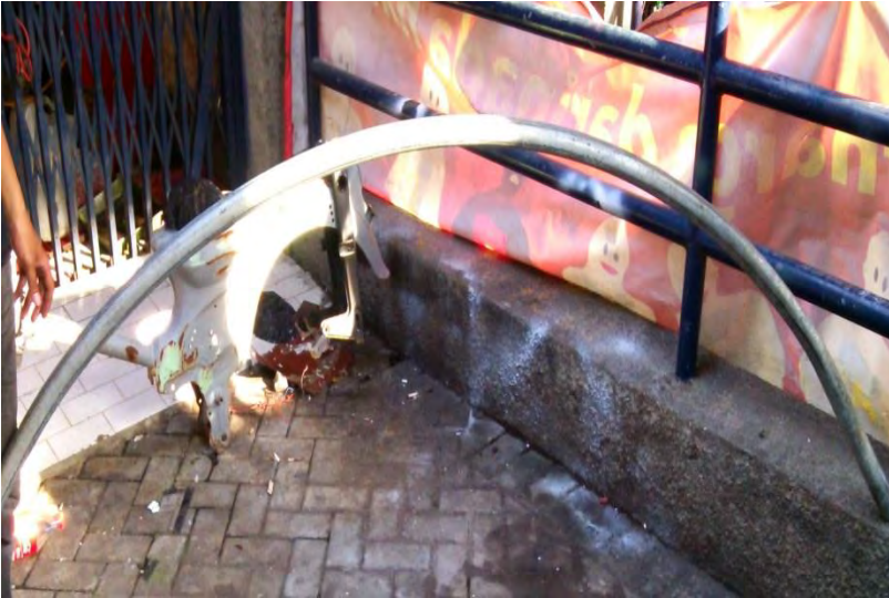
Gambar 4.11 Hasil uji coba pelengkungan pipa
