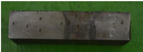
**Gambar 4.16 : Hasil Pengelasan Spesimen 150A**
