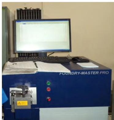
*Gambar 3.7 Mesin uji spektro.*
