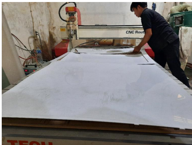
Gambar 6. 9 Proses potong pola menggunakan mesin CNC
