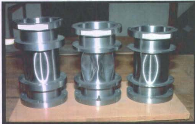
Gambar 2.10 Shell instability pada silinder
