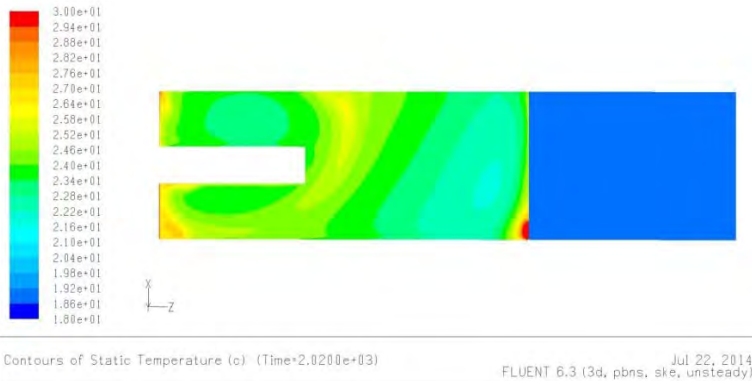
Gambar 4.17 Kontur temperatur ( ^{\circ}\text{C} ) pada y = 0,5 m pada variasi beban pendinginan siang pada detik ke-2000
