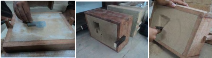
Gambar 4.12 (a) Pelepasan pola (b) Proses pengeringan (c) Pembuatan pouring basin
