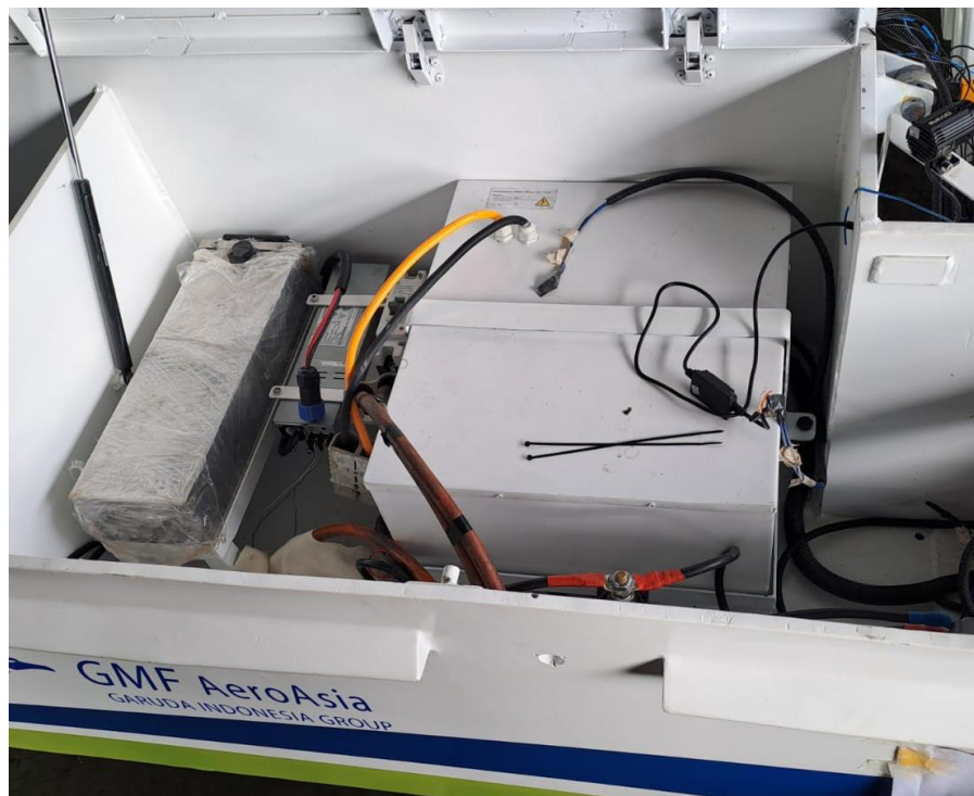
Gambar 4.21 Power baterai EV Pushback TUG ( Sumber : Dokumentasi pribadi )
