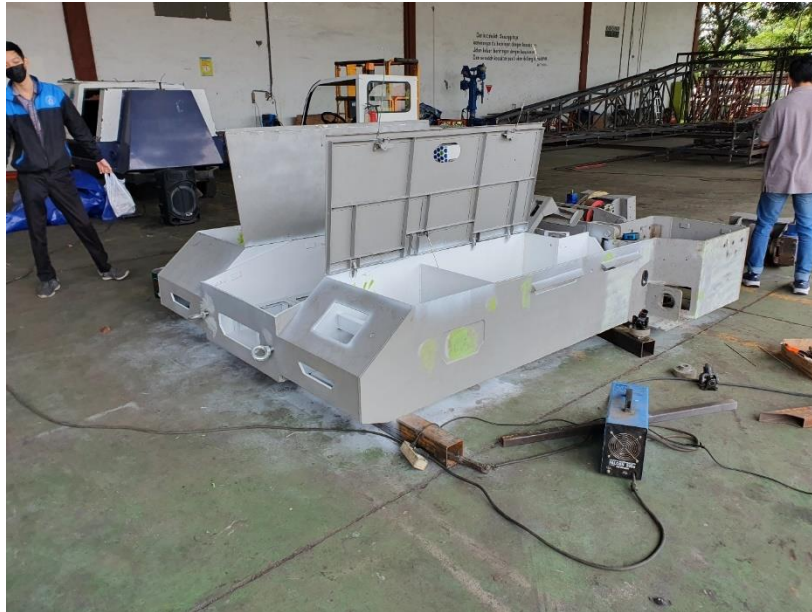
Gambar 4.4 Frame Pushback TUG ( Sumber : Dokumentasi pribadi )
