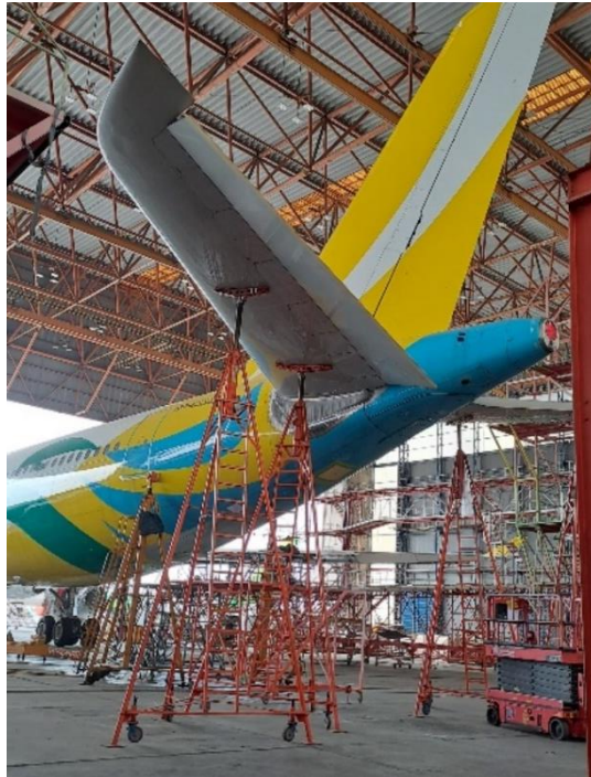
Jacking pesawat di Hanggar
