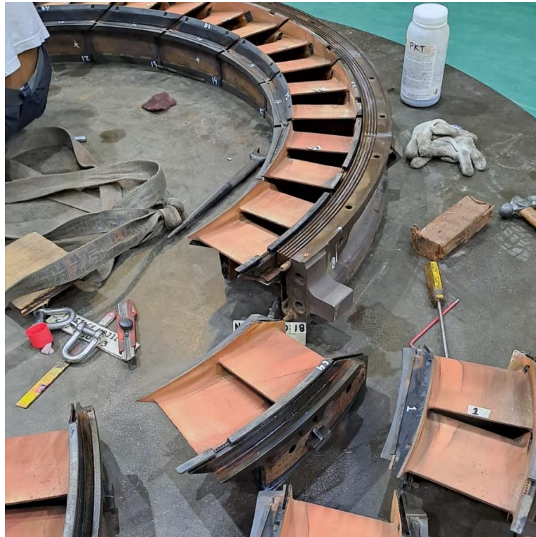
Identifikasi inlet guide vane pada gas turbine power plant
