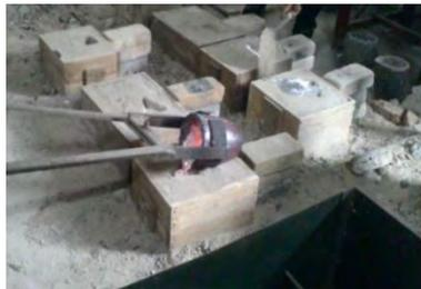
*Gambar 3.10 Proses penuangan Aluminium cair*
