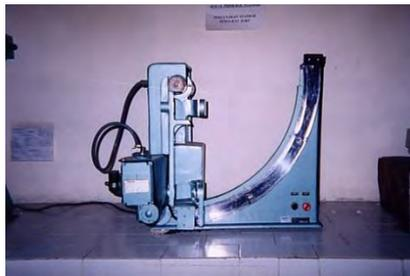
*Gambar 2.3 Mesin uji tekan pasir cetak*
