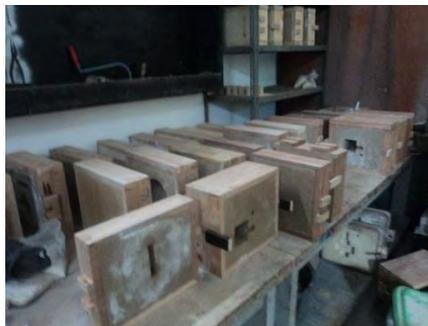
Gambar 4.14 Proses pengeringan cetakan pasir
