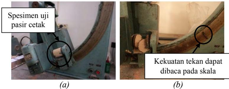
Gambar 4.10 (a) Uji kekuatan tekan pasir cetak (b) Penunjuk nilai kekuatan tekan
