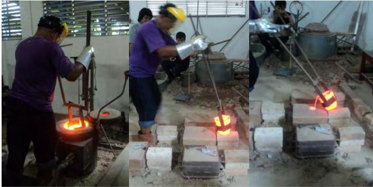
*Gambar 4.18 Proses penuangan aluminium cair*
