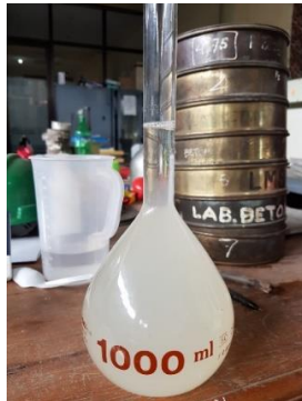
Gambar 3. 8 Pengujian Berat Jenis NaOH
