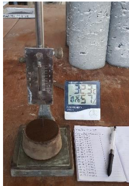
Gambar 3. 19 Pengujian Waktu Ikat Pasta Geopolimer
