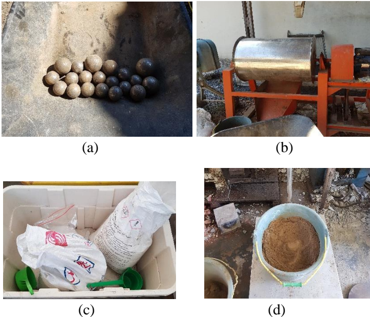
Gambar 3. 12 Alat dan Bahan Pembuatan Semen Geopolimer (a) Bola Pejal (b) Mesin Grinding (ball mill) (c) Alkali Aktivator (d) Fly ash
