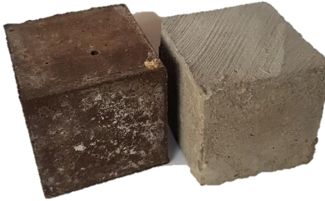
Gambar 3. 17 Benda Uji Mortar Geopolimar (kiri) Mortar Portland (kanan)
