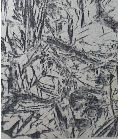
**Gambar 2. 8 Struktur Mikro Martensit [6]**
