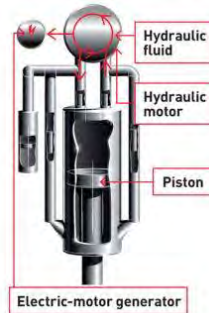
Gambar 2.11 Regenerative Shock Absorber dengan prinsip hidraulik [3]
