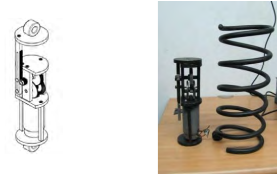
Gambar 2.5 FRSA VERS VI dengan pegas(spring) [10]
