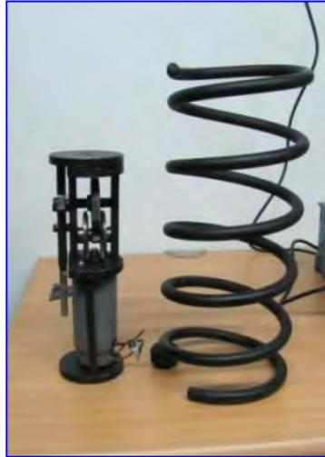
Gambar 2. 10 FRSA VERS VI dengan pegas (spring)<sup>[9]</sup>
