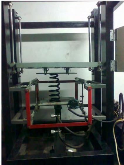
Gambar 4. 1Mekanisme Pengujian Pegas (*Spring*)
