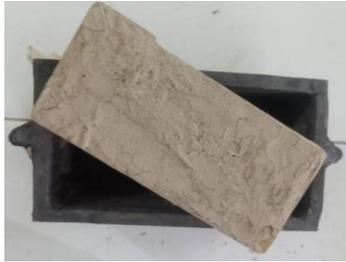
**Gambar 3.13** Wadah Reaksi dengan Lapisan Semen Alumina
