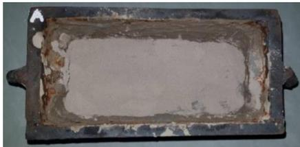
**Gambar 3.14** Bubuk Alumina pada Wadah Reaksi
