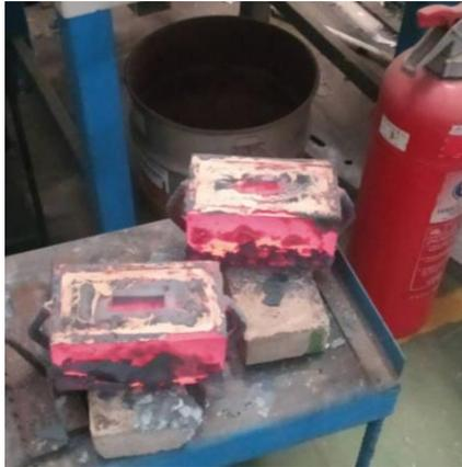
**Gambar 3.18** Wadah Reaksi saat Pendinginan menggunakan Udara Sekitar
