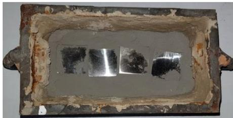
**Gambar 3.15** Spesimen Uji dan Formula saat dimasukkan ke dalam Wadah Reaksi
