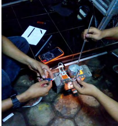
Gambar 4.8 Proses Pengukuran Temperatur Dengan Bejana Air Panas
