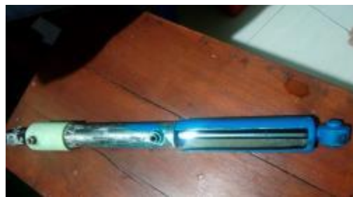
Gambar 4.167 Penyambungan dan Re-Painting Absorber
