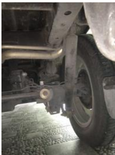
Gambar 3.15 Lokasi Pemasangan HMERSA Bagian Kanan Belakang Minibus
