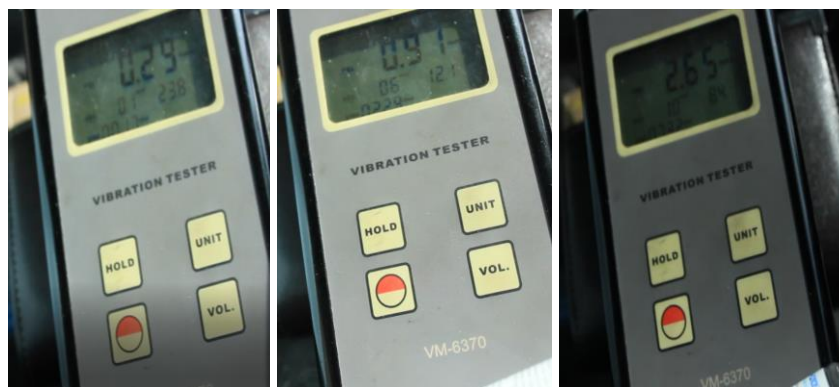
Gambar 4.342 Perbandingan Respon Dinamis Absorber Konvensional Melewati Speed Trap untuk Tiap Kecepatan
