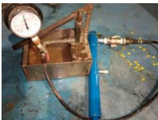
Gambar 4.178 Test Kebocoran Absorber yang telah dimodifikasi
