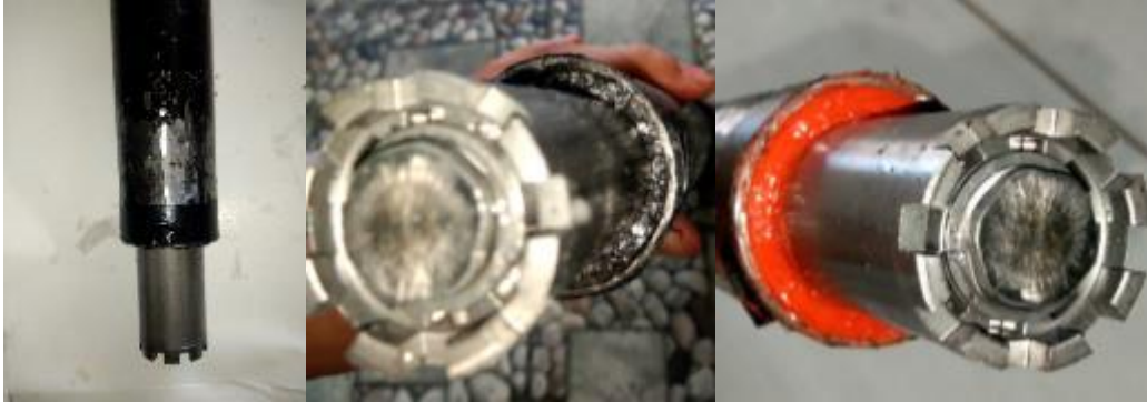
Gambar 4.156 Modifikasi tabung shock absorber (a) tanpa separator (b) Separator dengan karbon gland packing, (c) Penambahan red silicone
