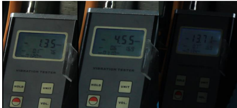
Gambar 4.295 Perbandingan Respon Dinamis HMERSA Seri Melewati Polisi Tidur untuk Tiap Kecepatan
