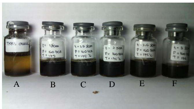
Gambar 4.2 hasil liquid pada proses hidrotermal dengan suhu 175 0 C, Tekanan 160 bar dan waktu reaksi 1-3 jam
