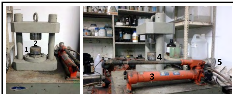
Gambar III.1 Alat pencetak briket
