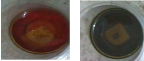
Gambar 3.13 Perendaman kaca TCO berlapis \text{TiO}_2 pada pewarna (a) Kulit manggis (b) Rhoeo spatachea
