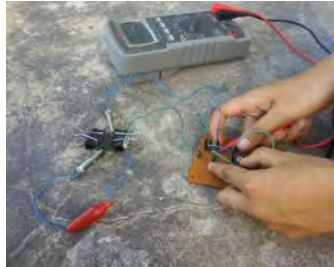
Gambar 3.16 Pengukuran arus dan tegangan dari DSSC
