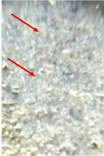
Gambar 4.5 Foto Perbesaran 60× Spesimen 30% Abu Sekam Padi, 30% MgO, dan 40% Resin Epoxy
