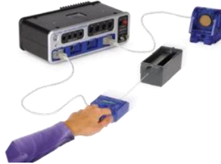
Gambar 3.5 Pengujian Koefisien Gesek
