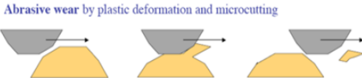
Gambar 2.12 Mekanisme keausan abrasif (H. Czichos, 1978)
