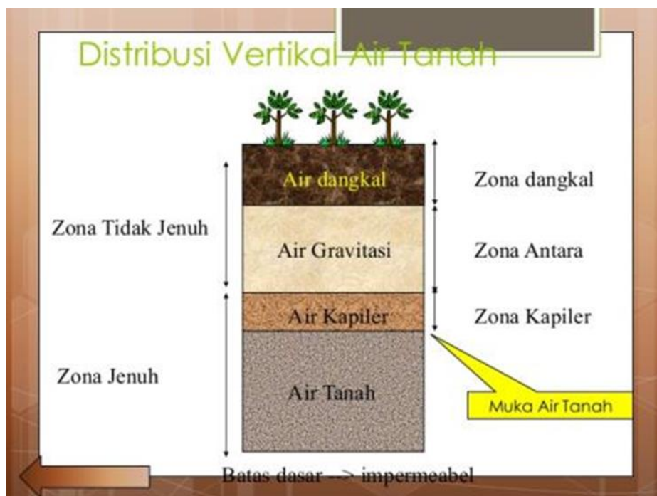
Gambar 2. 6 Skema distribusi air bawah permukaan (Pinder, 2011)
