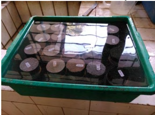
Gambar 3.10 Proses Curing mortar dengan perendaman didalam air
