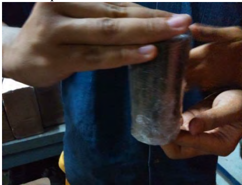
Gambar 3.11 Proses Curing Mortar dengan dimasukkan kedalam plastic
