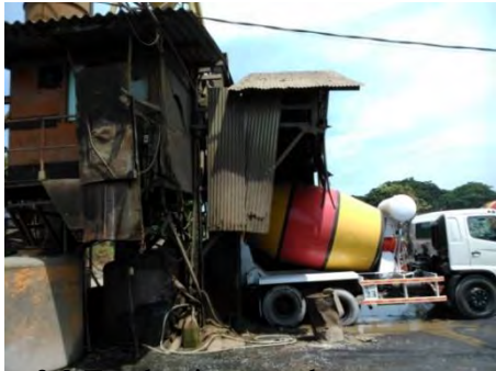
Gambar 3.2 Truck mixer untuk pencampuran beton
