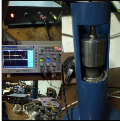
Gambar 2.10 Alat Bender Elemen yang dikembangkan oleh GDS Instrument Belanda
