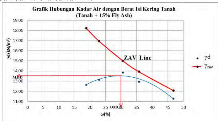
Gambar 4.25 Grafik hubungan kadar air optimum ( \omega_c ) dengan berat volume kering maksimum ( \gamma_d ) tanah natural + 15% fly ash .
