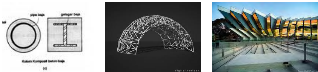
Gambar 7.1: kolom baja komposit, space frame, ACP
